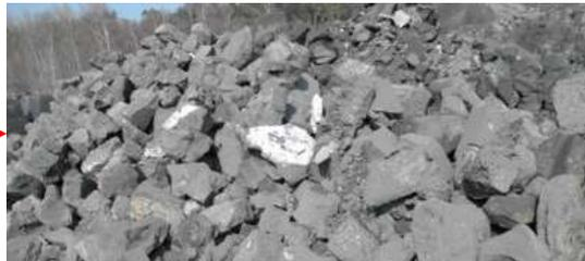
Salzschlacke ist ein Reststoff, der bei der Einschmelzung von Al-Schrotten unter Salz anfällt – In Stockach erfolgt eine vollständige Wiederaufbereitung
